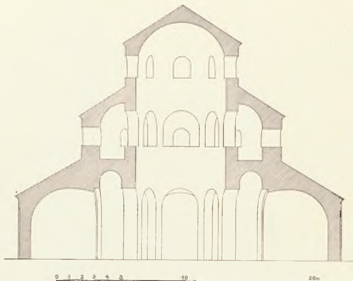
Václavova rotunda svatovítská. Rekonstrukce, osový řez.
